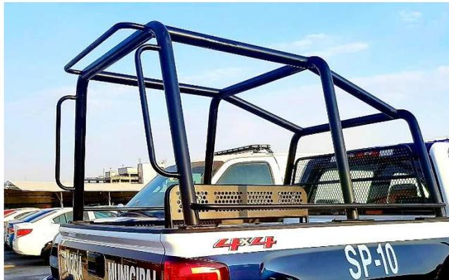
Estructura del Cuerpo Tubo Acero al carbón-rolado en frío, calibre 14 de 3" de diámetro.
