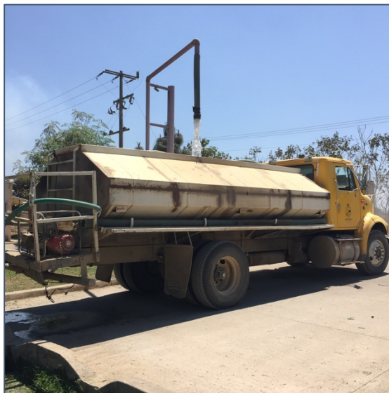
Fotografía 7 Llenado de pipa con agua residual tratada en PTAR 2 de Zapotlán
